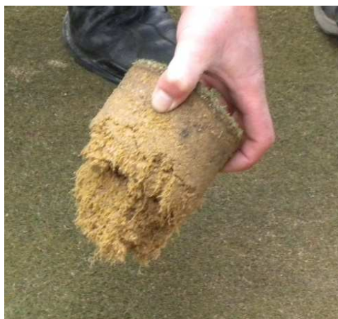
Cilindres d'arrels de gespa on veiem la profunditat on baixa la humitat.
