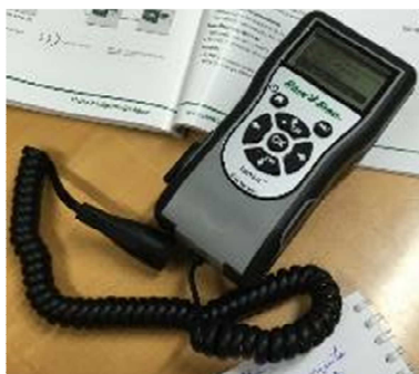
Connexió de la consola amb el programador via infrarojos o via ràdio
