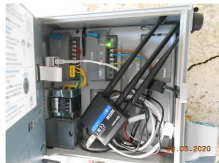
Programador amb mòdul de comunicació, "router" amb SIM i connexió al mòdul amb cable "Ethernet"
