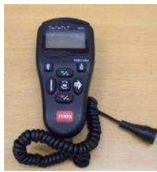
Connexió de la consola amb el programador via infrarojos o via ràdio
