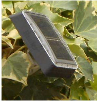
Programador a piles, alguns poden portar petit panell solar i bateria recarregable
