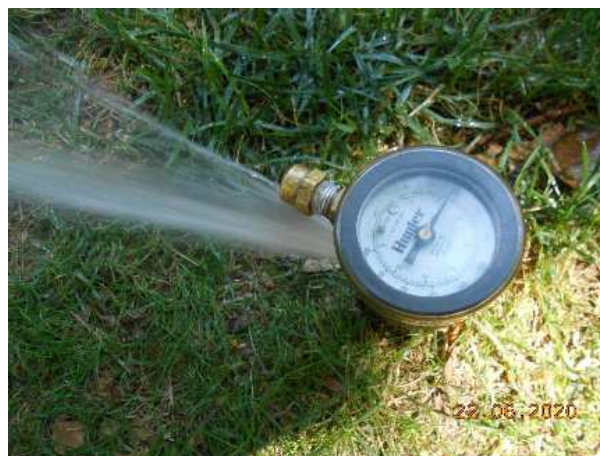
Mesura de la pressió a la que rega un aspersor utilitzant un manòmetre d'agulla
