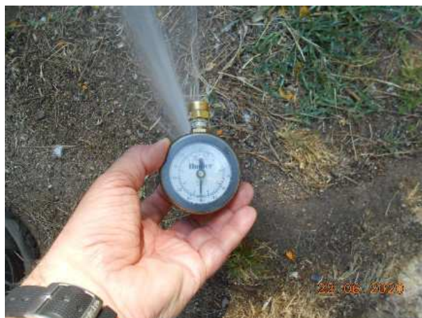
Mesura de la pressió a la que rega un aspersor utilitzant un manòmetre d'agulla
